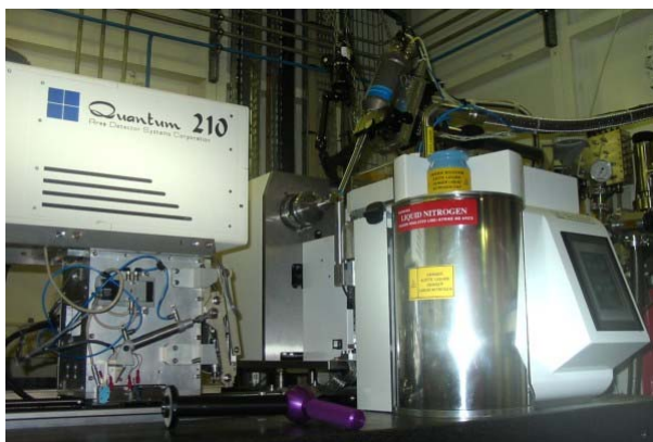
Obr. 3. Proteinový difraktometr u RTG svazku ID14-1 (beam line) synchrotronu ESRF v Grenoblu 10 . Toto zařízení je samozřejmě podstatně větší než laboratorní difraktometr na obr. 2
