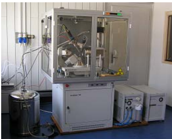
Obr. 2. Laboratorní monokrystalový RTG difraktometr pro řešení struktury malých molekul. Zleva doprava: kontejner s kapalným dusíkem, čtyřkruhový goniometr s měřeným monokrystalem a pod ním zdroj RTG záření, chlazení RTG lampy, chlazení detektoru difraktovaných paprsků
