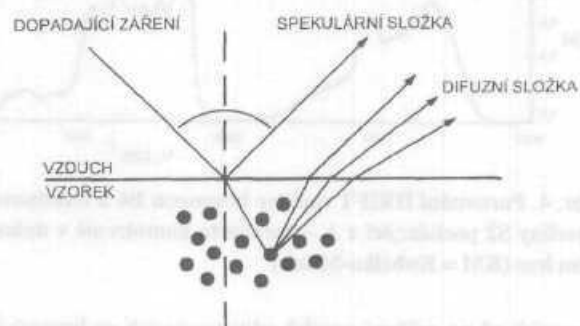
Obr. 1. Schéma interakce infračerveného záření se vzorkem v DRIFT cele
