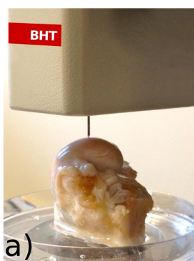
Obr. 4. Bioindenter při indentaci kolenní chrupavky kozy (a), srovnání indentačních křivek obržených na zdravé a obnovující se chrupavce téhož laboratorního zvířete (indentace kulovým hrotem s poloměrem 0,5 mm) (b)
