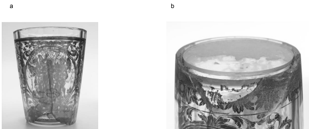
Obr. 7. Historická sklenice rekonstruovaná s pomocí přípravku na bázi 2-HEMA. a) příklad lepení skla na podklad, b) detail přísazení náhradního dna
