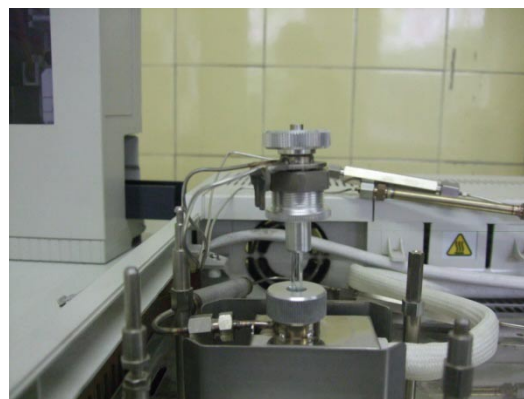
Obr. 2. Upravený injektor GC-MS pre použitie SPMCE metódy
