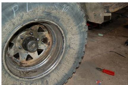
Obr. 2. Koleso na vozidle s upravenou stredovou časťou disku
