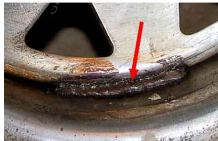
Obr. 3. Detail posunu privarenej stredovej časti disku
