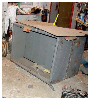
Obr. 14. Tlakové poškodenie pracovnej dosky stola
