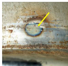
Obr. 21. Tepelná stopa po prehriati na vnútornej strane ráfika disku
