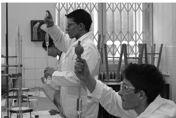
Obr. 1. Úkolem praktické části bylo acidimetrické stanovení účinné látky v Acylpyrinu
