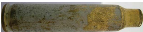
Obr. 7. Fotografie vizualizace otisku prostřednictvím potenciostatické depozice PANI (koncentrace monomeru 0,3 M) při 0,6 V z 0,1 M Na 2 C 2 O 4 po dobu 85 s (upraveno podle cit. 10 )
