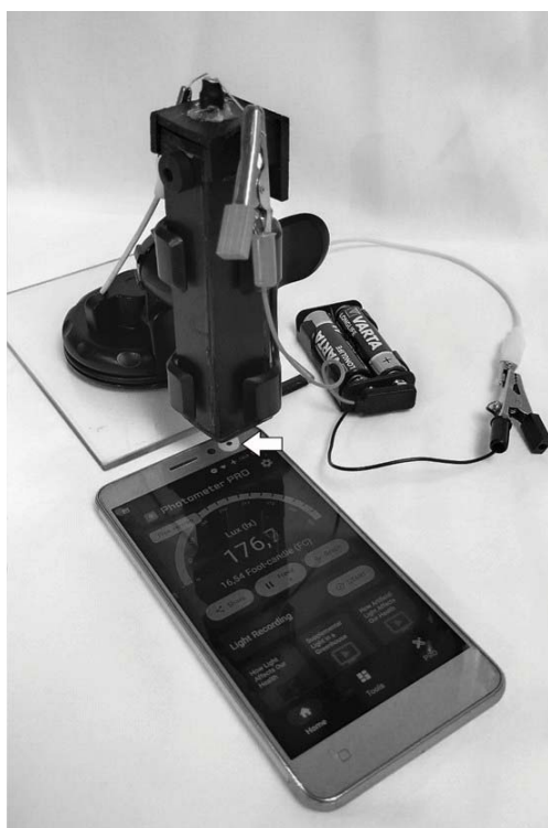
Obr. 2. Sestavená aparatura pro polarimetrické měření. V držáku na mobil upevněna vytvořená polarimetrická kyveta, přes kterou je prosvěcováno pomocí LED diody. S mobilem se pak manipuluje tak, aby senzor zachytil co nejvíce propuštěného světla přes polarimetrickou kyvetu – vycentrovaný paprsek – viz šipka
