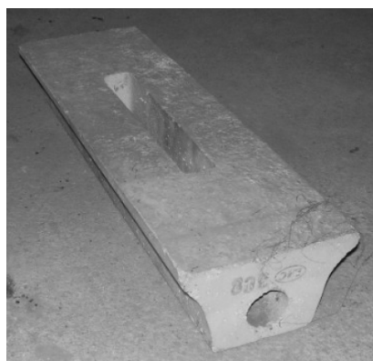
Obr. 2. Pôvodná tvarovka trysky
